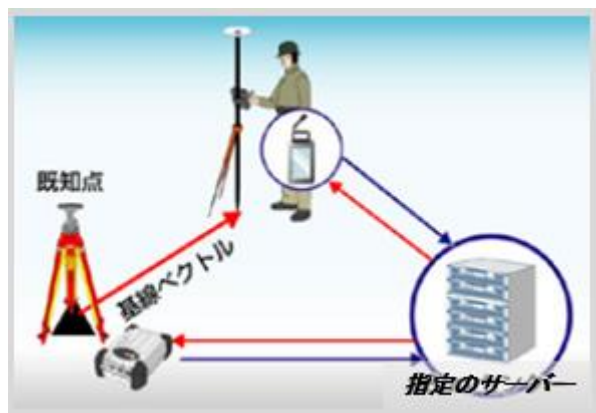
図5.4 サーバーを使用したRTK
