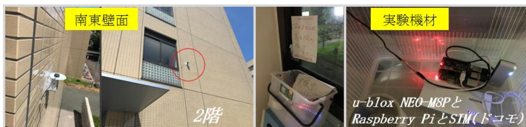
図 4.19 アンテナ設置状況と使用機材
