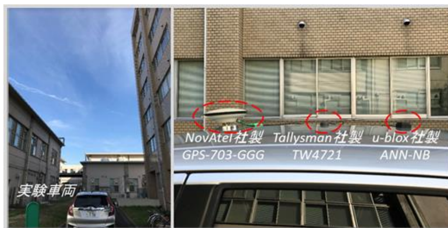
図3.10 実験風景と移動局のGNSSアンテナ
